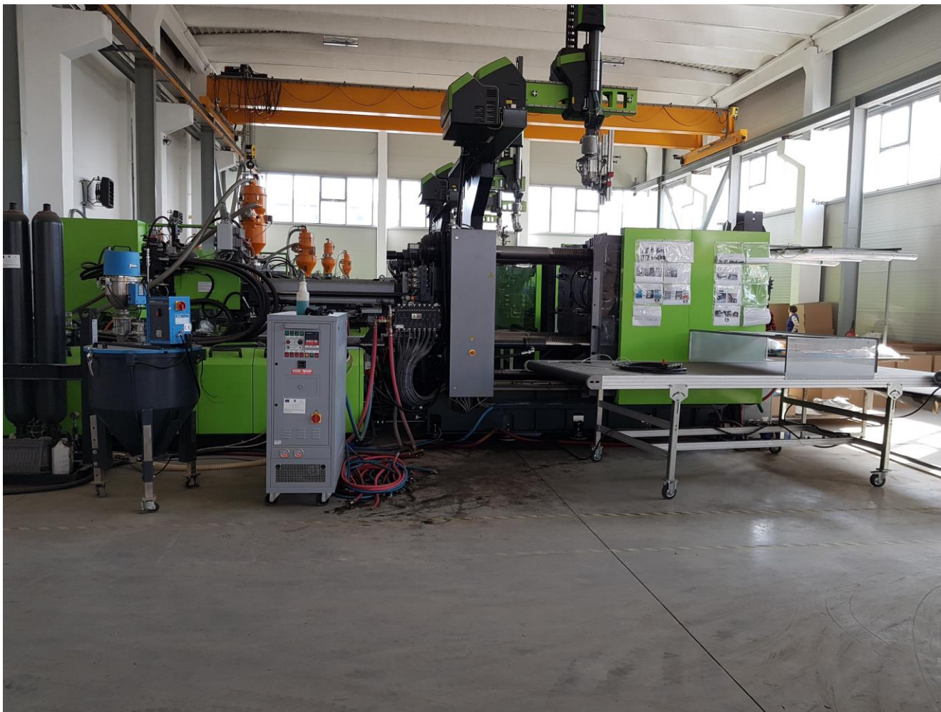
Fig.4.5 Utilaje Producere prin injecție a pieselor din material plastic
