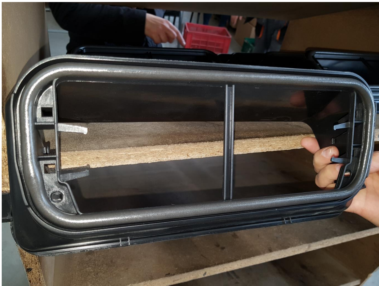
Fig.4.4.- Componente auto cu strat de spuma poliuretanică aplicat pe material plastic
