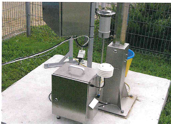
Figura nr. 2.3.1. Sistem prelevare particule în suspensie LVS3 utilizat la determinarea PM 10
