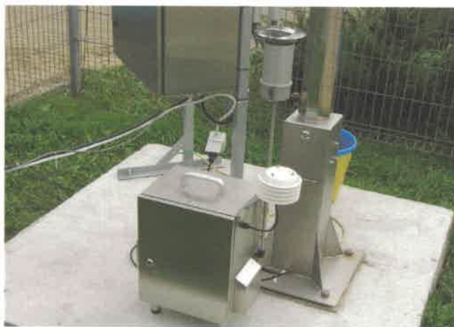
Figura nr. 2.3.1. Sistem prelevare particule în suspensie LVS3 utilizat la determinarea PM 10
