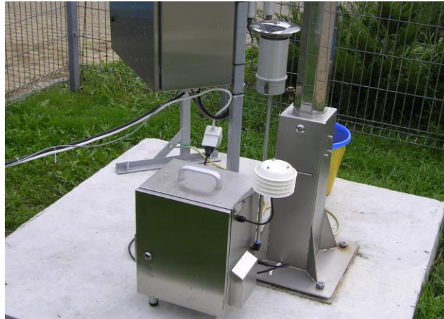
Figura nr. 2.3.1. Sistem prelevare particule in suspensie LVS3 utilizat la determinarea PM_{10}
