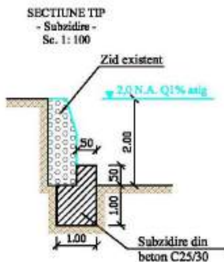
Figura 2 - Secțiune Tip - Subzidire
