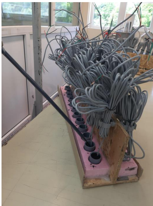
Figura 5. - Încapsulare cu spumă poliuretanică a subsamblurilor electronice (Potting)
