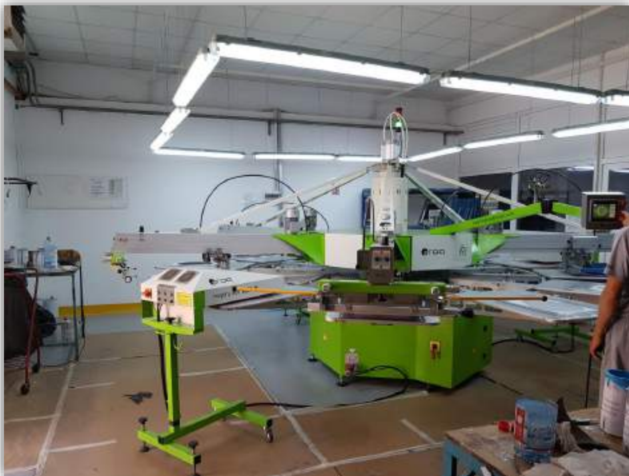
Figura 16. Mașina de serigrafie cu 12 posturi pentru inscripționări pe piele
