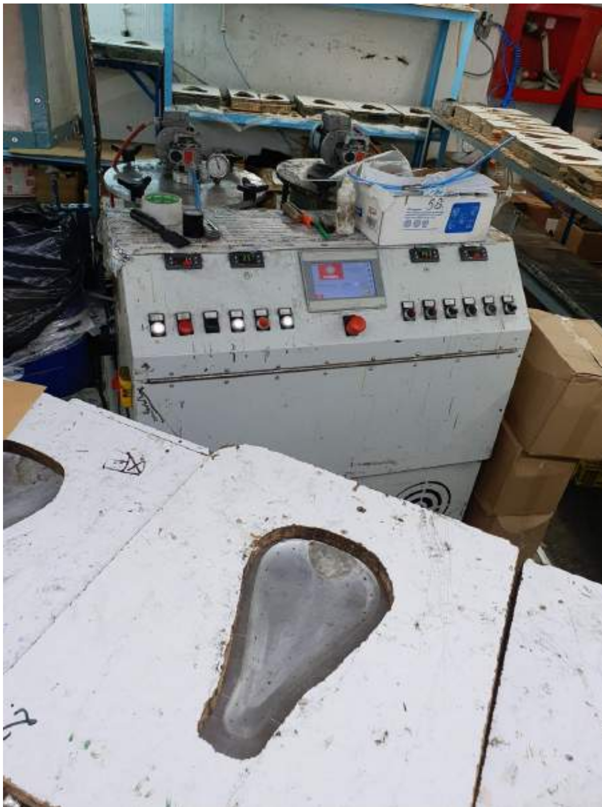
Figura 2. Linie mobilă pentru turnare componente poliuretanică
