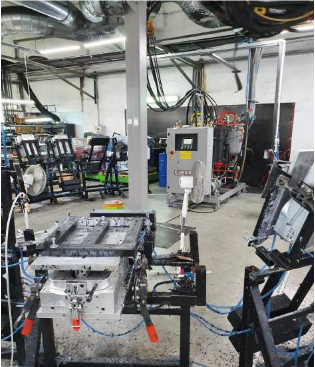
Figura 1. Linie fixa pentru turnare componente poliuretanic
