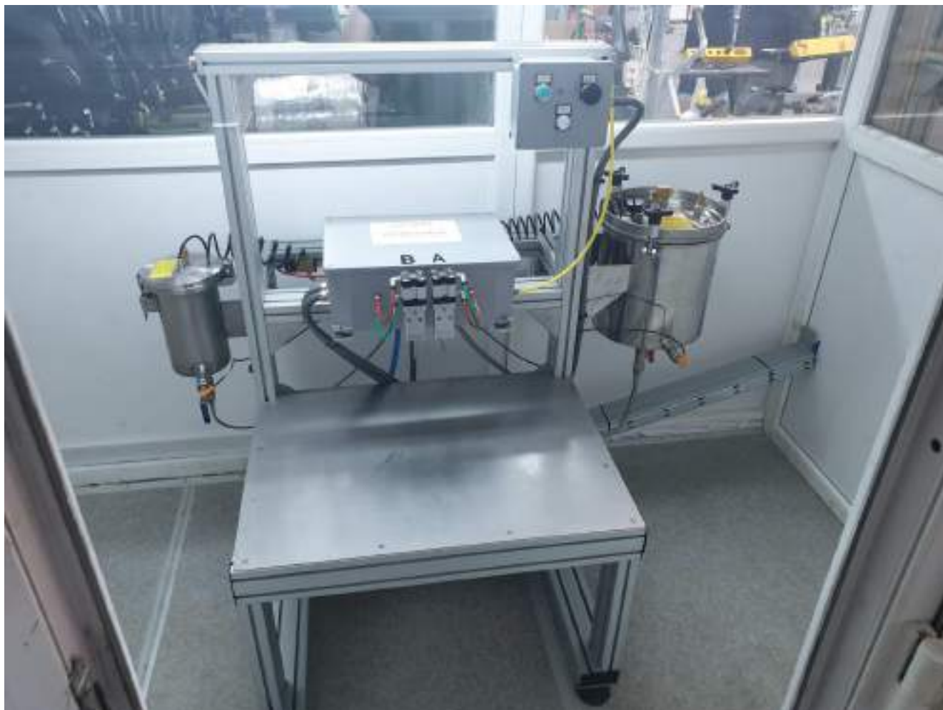
Figura 13. Utilaj preparare adeziv din camera de preparare adeziv
