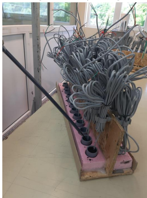
Figura 5. - Încapsulare cu spumă poliuretanică a subsansamblurilor electronice (Potting)
