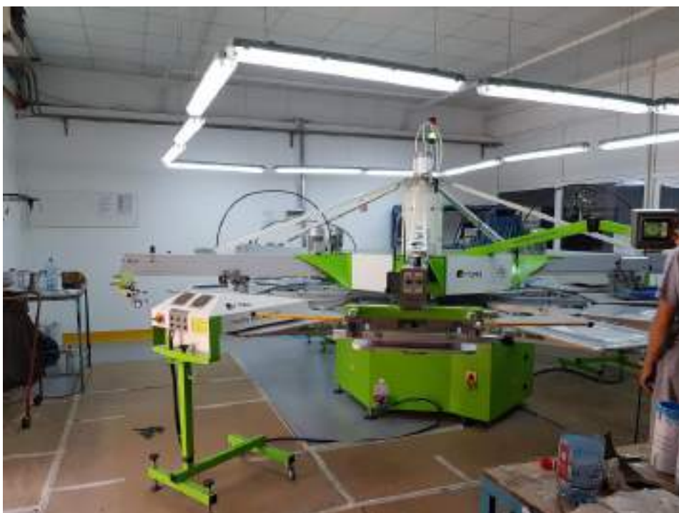
Figura 18. Mașina de serigrafie cu 12 posturi pentru inscripționări pe piele
