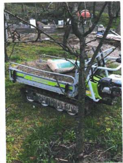
Figura 5. Minidumper pe șenile din cauciuc a cărui utilizare pe terenuri fragile asigură o protecție a solului și a covorului de vegetație
