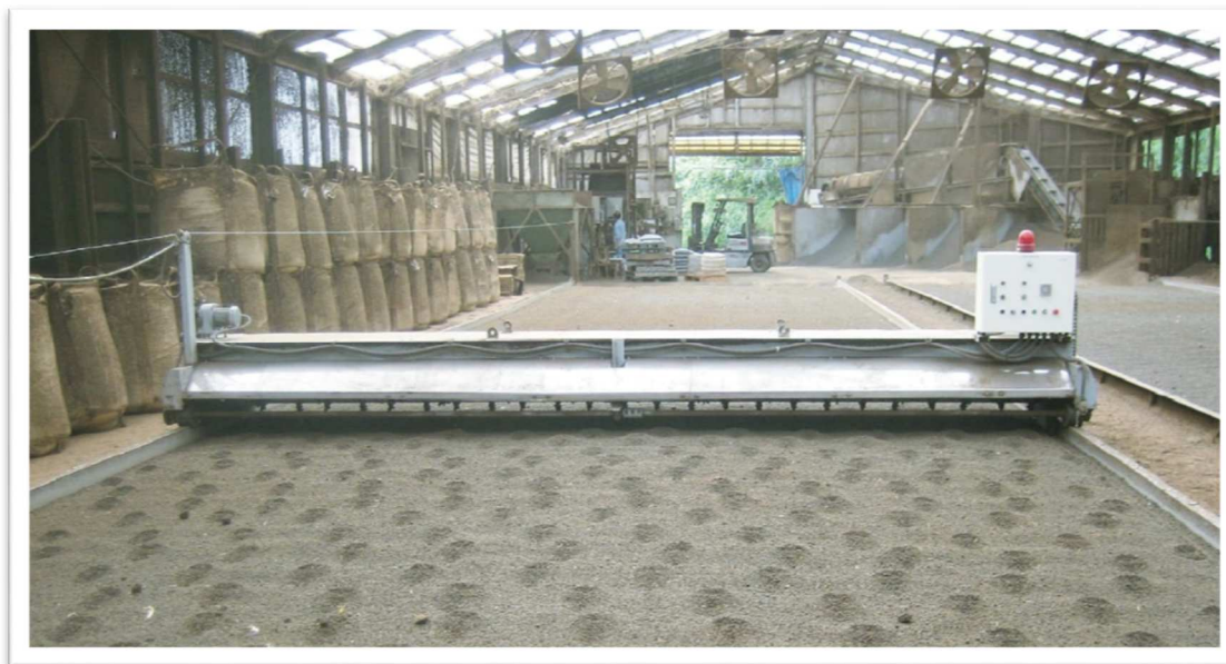
Tava de uscare definitivă pe care glisează un dispozitiv special pentru ajustarea formei și dimensiunii granulelor
