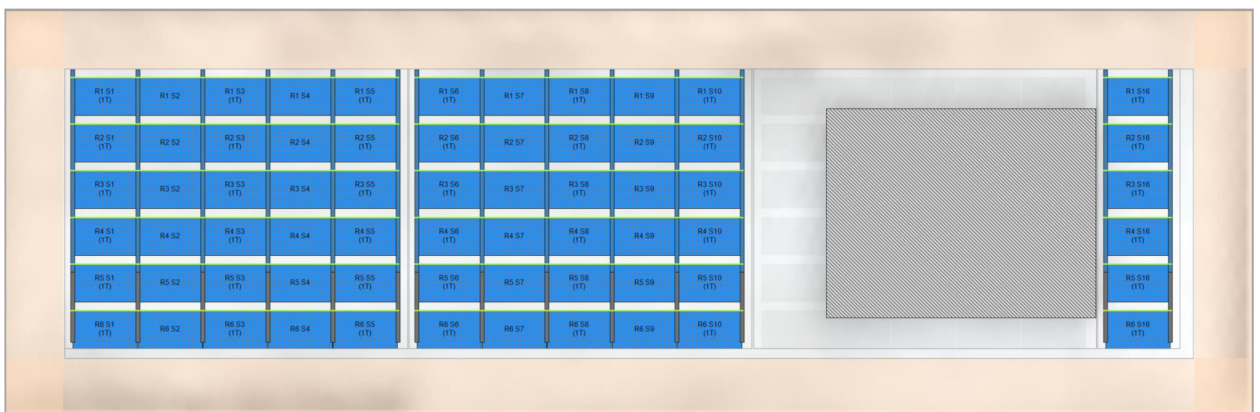
Fig. 6: Configuratie panouri fotovoltaice zona 6
