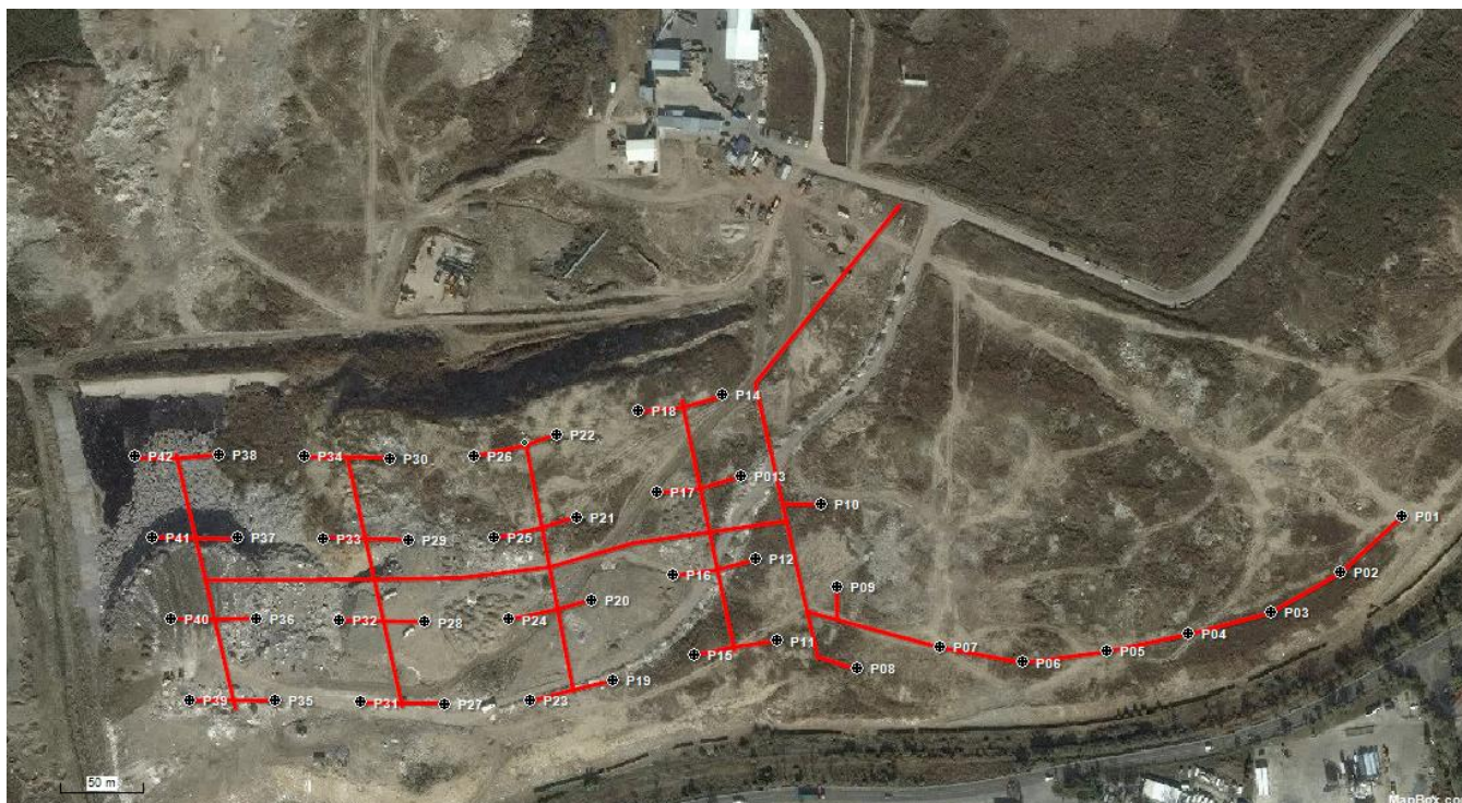
Reteaua de captare, transport si ardere a biogazului in incinta depozitului pentru deseuri nepericuloase Glina
