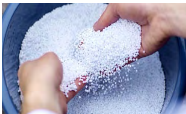
Materia primă realizată în spațiu de producție din materiale plastice reciclate (rPET granule)
