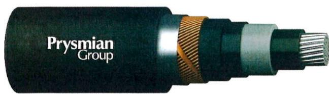
Cabluri de medie tensiune pentru tensiuni nominale de la 6 kV ( $U_m = 7,2$  kV) până la 30 kV ( $U_m = 36$  kV) utilizate în aplicații în aer liber, cum ar fi instalațiile industriale și stațiile electrice. Cablurile sunt adecvate pentru a fi așezate în pământ, în șanț sau în conducte, în apă, în aer liber sau în interior. Pătrunderea apei în cazul unei învelișuri exterioare deteriorate este limitată de zona ecranului etanș longitudinal și transversal.
