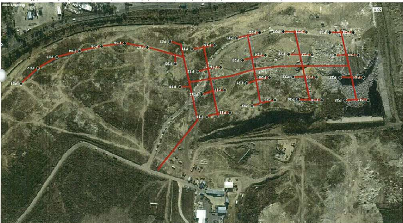
Rețeaua de captare, transport și ardere a biogazului în incinta depozitului pentru deseurii nepericuloase Gîlna
