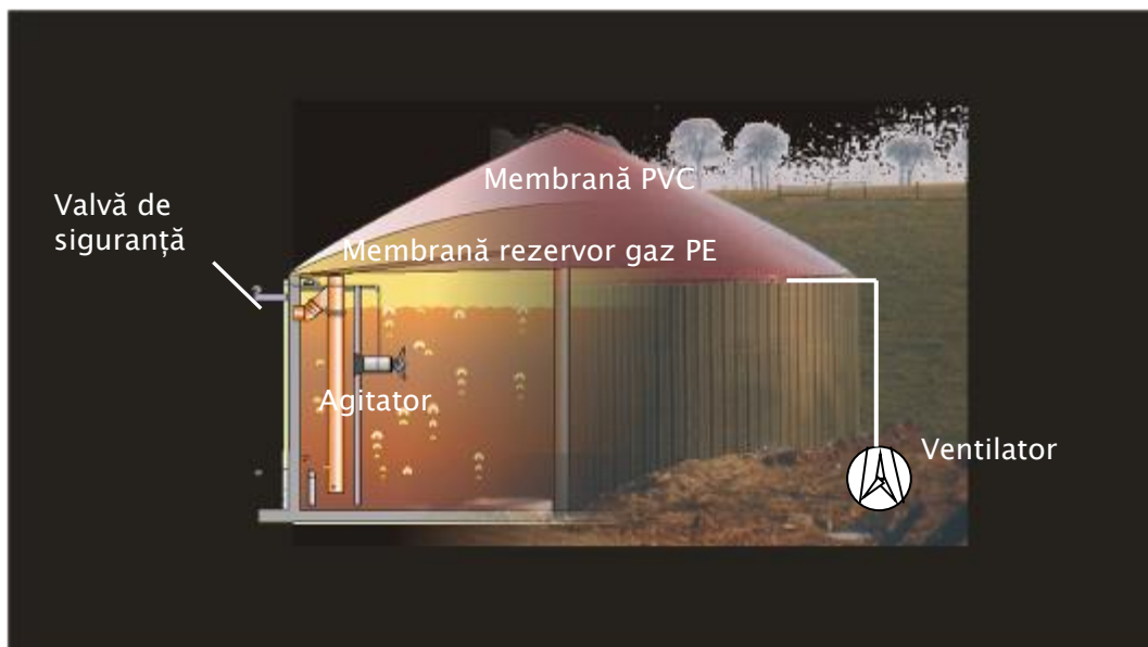
Figura nr. 14 - Reprezentarea schematică a sistemelor componente ale acoperișului de stocare a gazului și a elementelor de siguranță auxiliare
