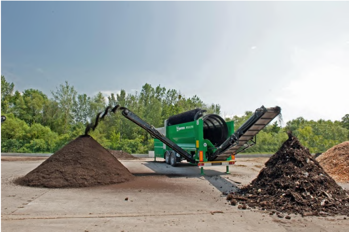
Figure 14 - Exemplu de compost cernut și de material refuz care se transportă către granulatorul de RDF.
