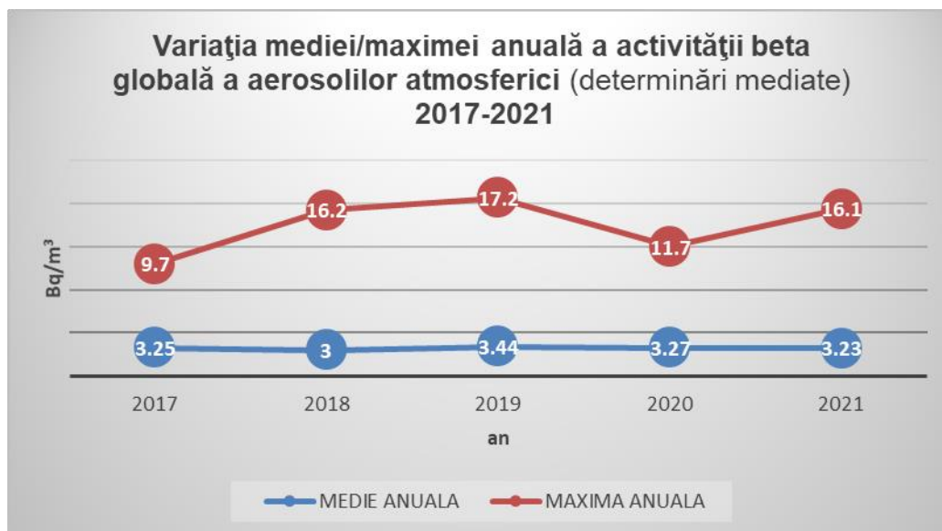
Figura nr. IX.1.1.3 - Variația mediei/maximei anuale a activității beta globală a aerosolilor atmosferici (determinări imediate) (Bq/m 3 )
