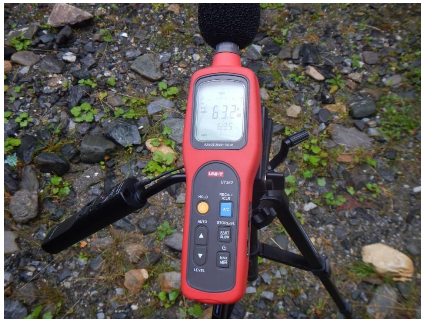
Figura 27. Sonometrul UNI-T model UT350 utilizat pentru măsurarea nivelului de zgomot în perimetrul Măgura Stănești
