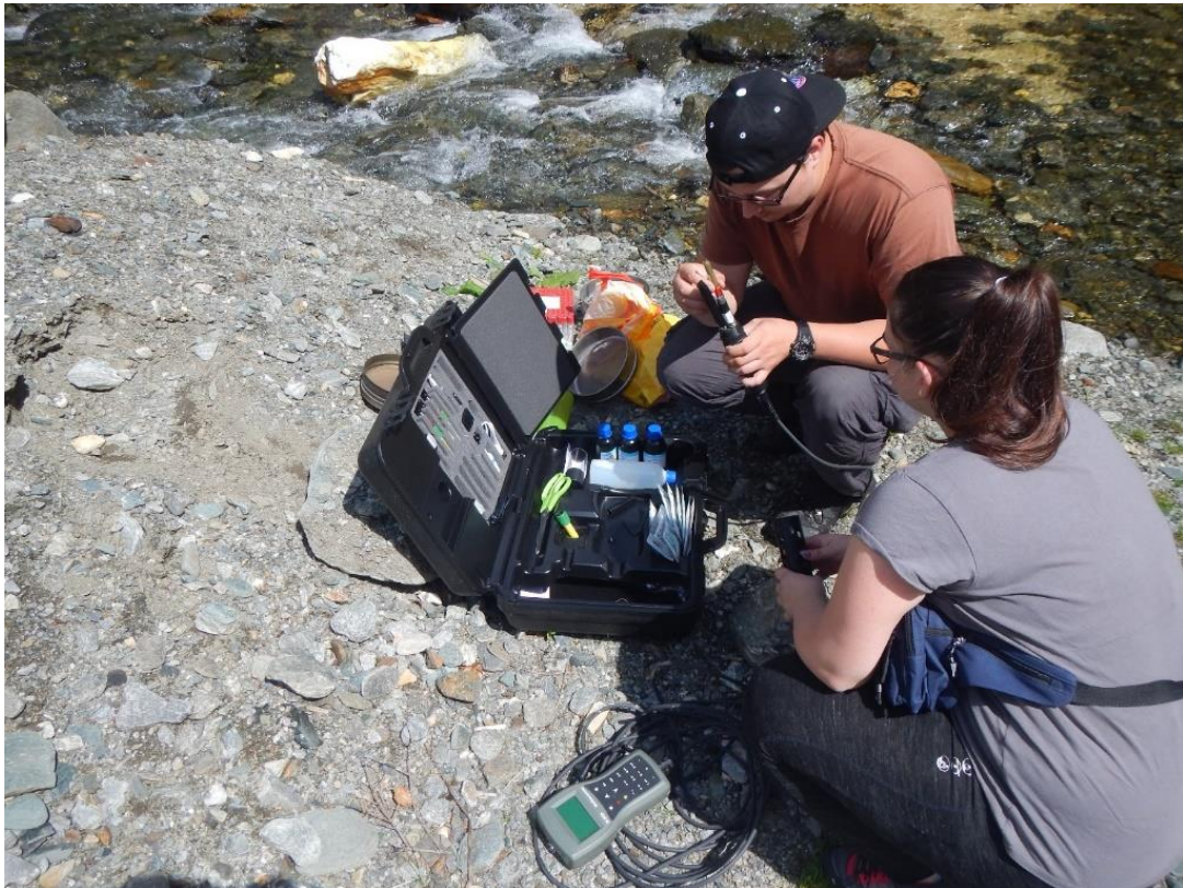
Figura 21. Măsurarea turbidității apei cu ajutorul analizorului portabil multiparametru Hanna 9289
