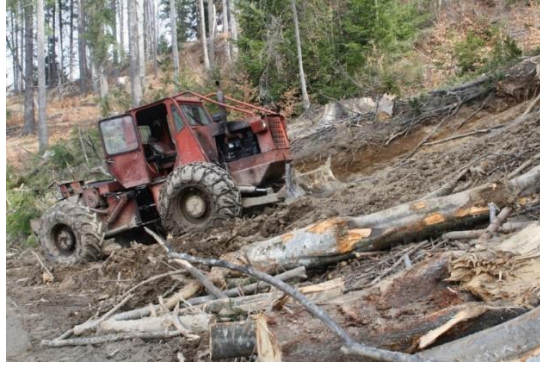
Figura 5. Ilustrarea impactului asociat unei defrișări asupra solului. Se observă ogașele profunde cauzate de târârea materialului lemnos și practicarea unor trasee pe pante înclinate ce favorizează formarea de torenți; se observă de asemenea expunerea unor largi fronturi ce expun sistemele radiculare ale arborilor proximali, fapt ce conduce la generarea unor unde de distorsiune arborilor din proximitate
