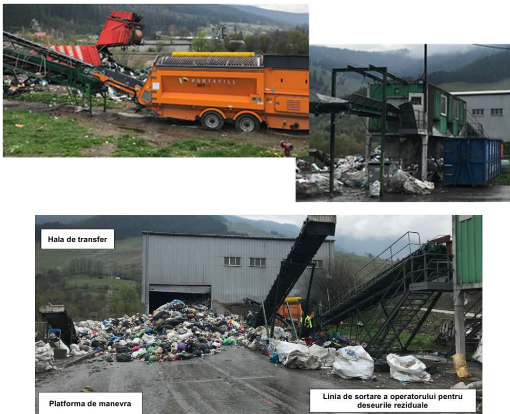
Figura 11 Hala de transfer și linia de sortare
