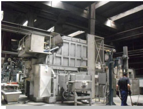
Figura 6 - Cuptor cu gaze naturale tip ZPF
