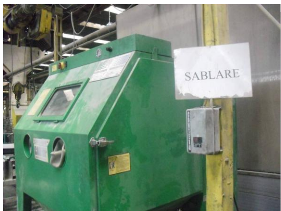
Fig.13. - Instalație de sablare cu alice din sticlă
