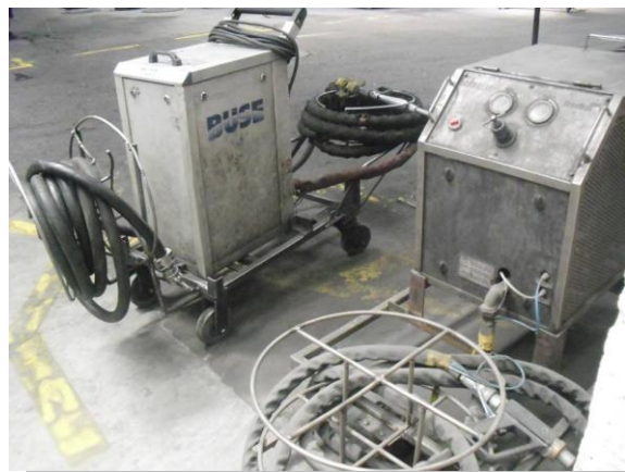
Fig.14. - Instalații de sablare cu zăpadă carbonică
