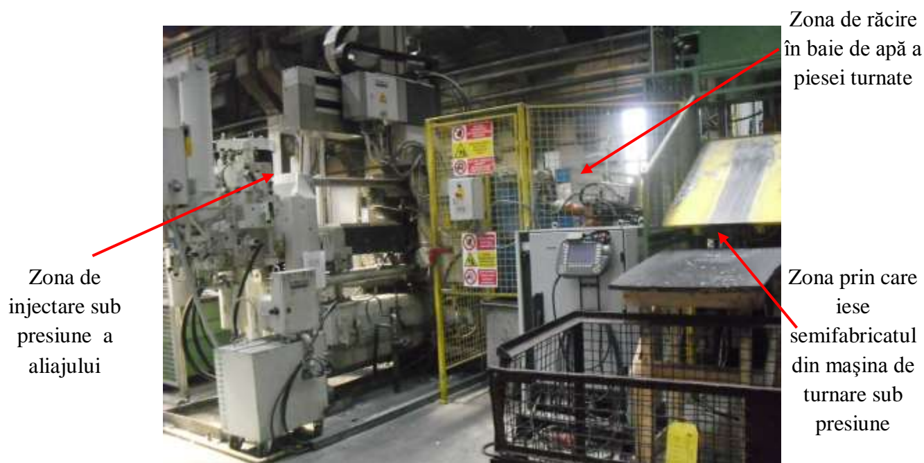
Fig. 17 - Turnarea mecanizată pe mașini de turnare sub presiune
