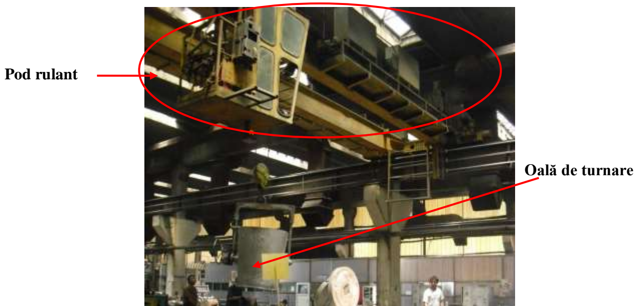
Fig. 13 - Transportul oalei de turnat de la cuptorul de topire la cuptoarele de menținere
