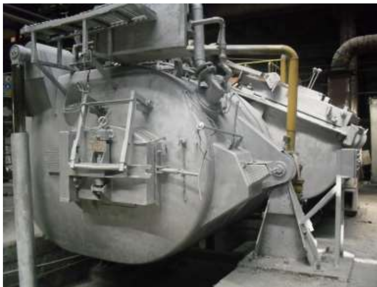
Figura 10 - Cuptor cu gaze naturale tip KOPPATZ
