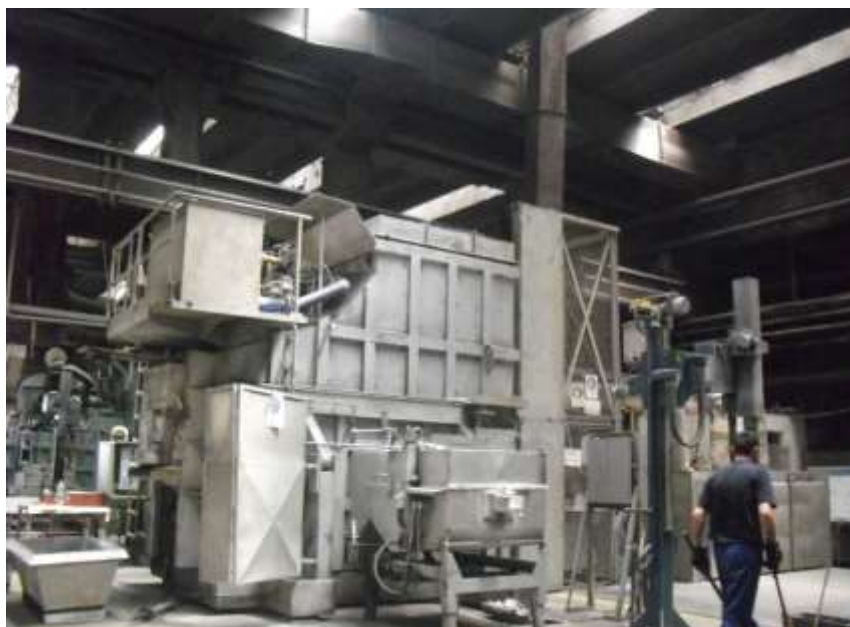
Figura 7 - Cuptor cu gaze naturale tip ZPF
