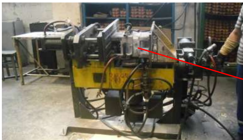
Fig. 20. - Instalații de împușcat miezuri
