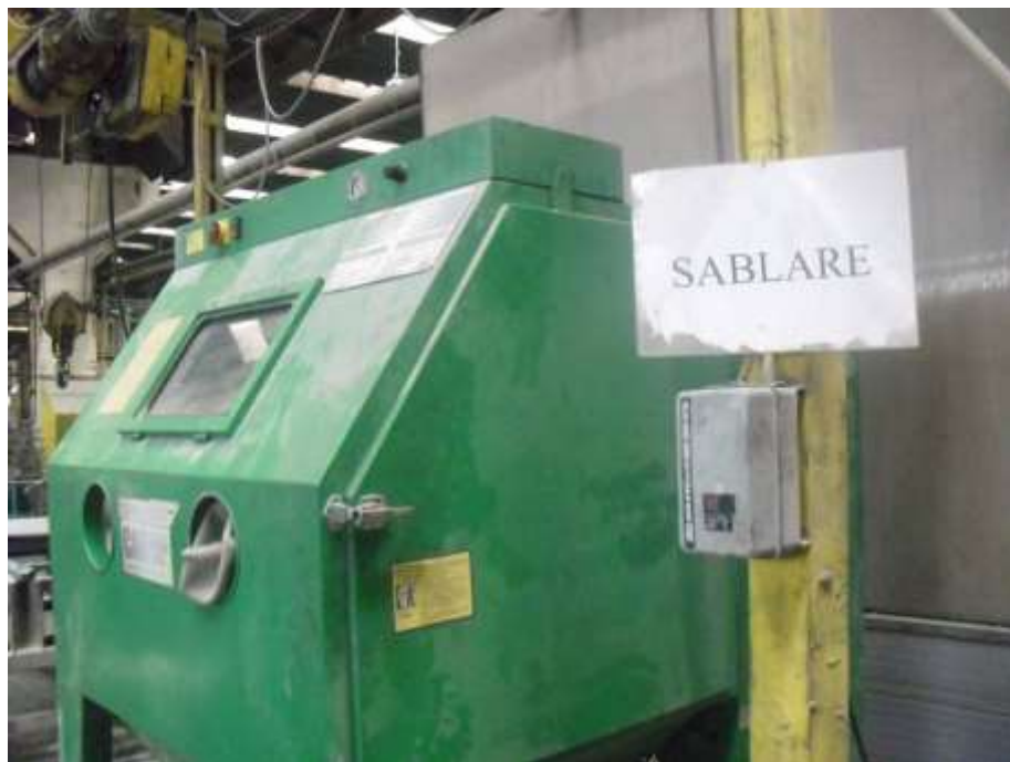
Fig.18. - Instalație de sablare cu alice din sticlă
