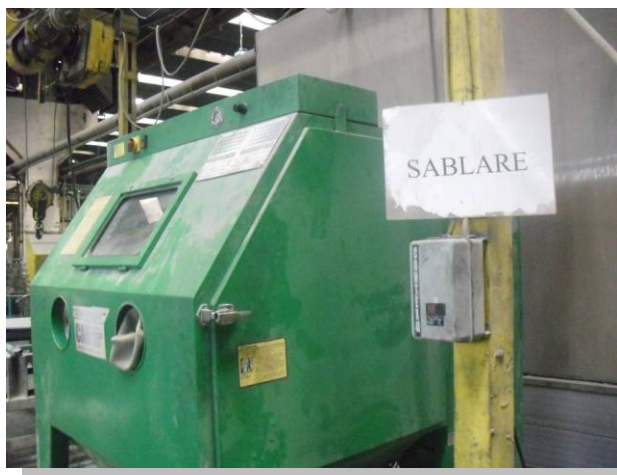
Fig.13. - Instalație de sablare cu alice din sticlă
