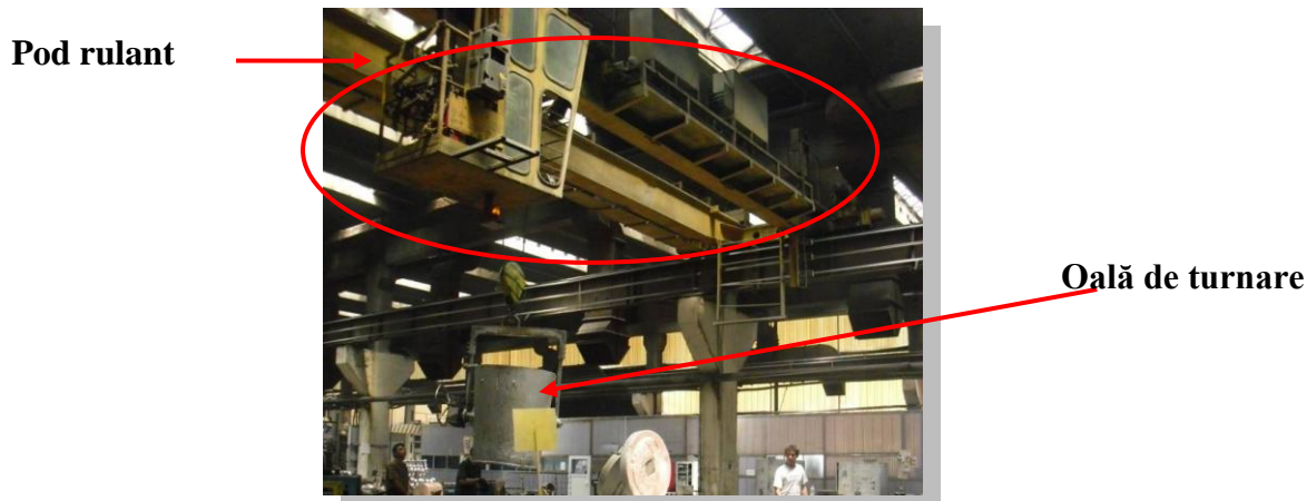
Fig. 11 - Transportul oalei de turnat de la cuptorul de topire la cuptoarele de menținere
