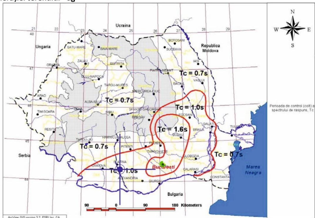
Planul de amenajare a teritoriului național - Secțiunea a V-a: Zone de risc natural – Perioada de control(colt) a spectrului de răspuns, Tc
