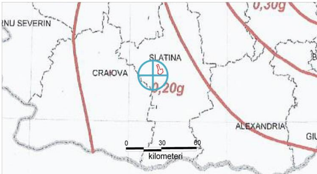
Figura nr. 25 - Cod de proiectare seismică - valoare de vârf a accelerației terenului
