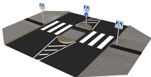
Figura 31: Exemplu de măsuri implementate în zona unei treceri pentru pietoni (Sursă: Search Corporation- Catalog de măsuri pentru siguranța circulației în satele liniare, 2007)
