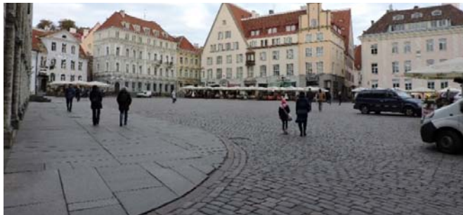
Figura 133: Exemplificări bune-practici: Spații “utilizate în comun”, partajate (“shared-space”), cu o slabă diferențiere a carosabilului și circulației pietonale (nivel comun, textură asemănătoare deși sesizabil diferențiată), în zone centrale și/sau comerciale sau de agrement
