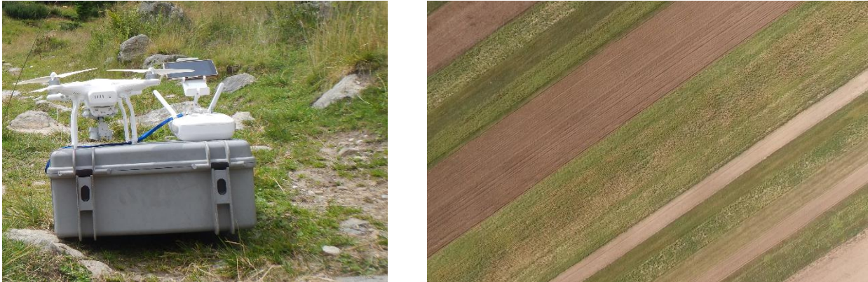
Figura 2. Drona DJI Phantom III-Advanced pregătită de zbor (stânga) și aerofotogramă (dreapta) – se observă nivelul de detaliu al aerofotogramei obținute
