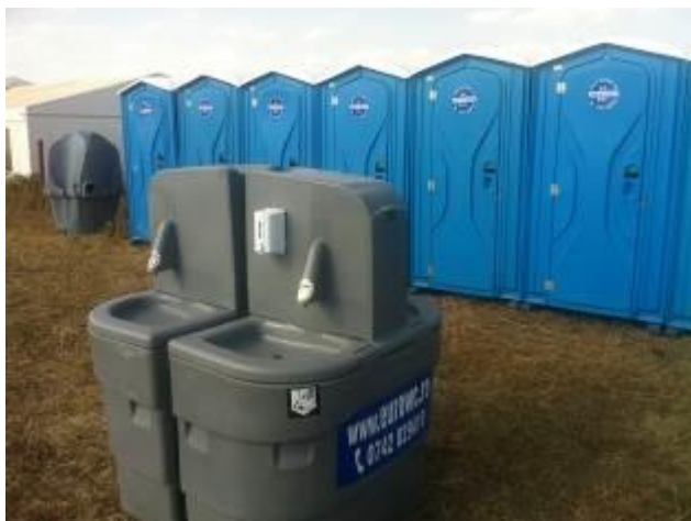
Figura 3 Modele de soluții de asigurarea a condițiilor de igienă pe amplasamente temporare (organizări de șantier, fronturi de lucru, etc.): toalete ecologice, cu bazin etanș, vidanjabil, tratat chimic; lavoare de spălare cu rezervoare etanșe ce asigură apa de spălare ce este apoi re-introdusă în rezervor distinct, etanș, vidanjabil (stânga); cabină de duș modulară cu rezervoare etanșe distincte: rezervor apă pentru spălare, rezervor etanș, vidanjabil pentru apa utilizată (dreapta)
