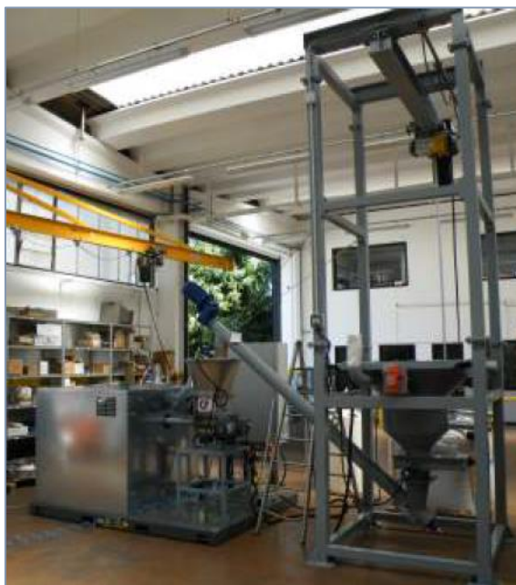
Componente de alimentare a sistemului de desulfurare a gazelor
