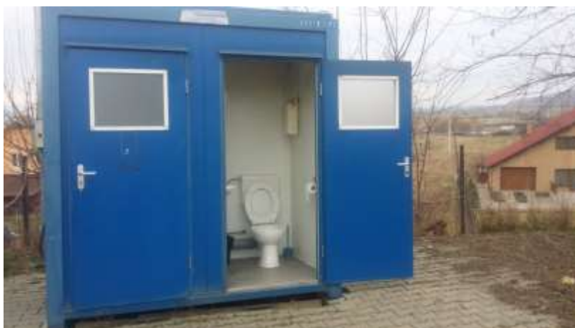
Container modular cu bazin vidanjabil, tratat chimic, dotat cu grup sanitar (toaletă și dușuri).
