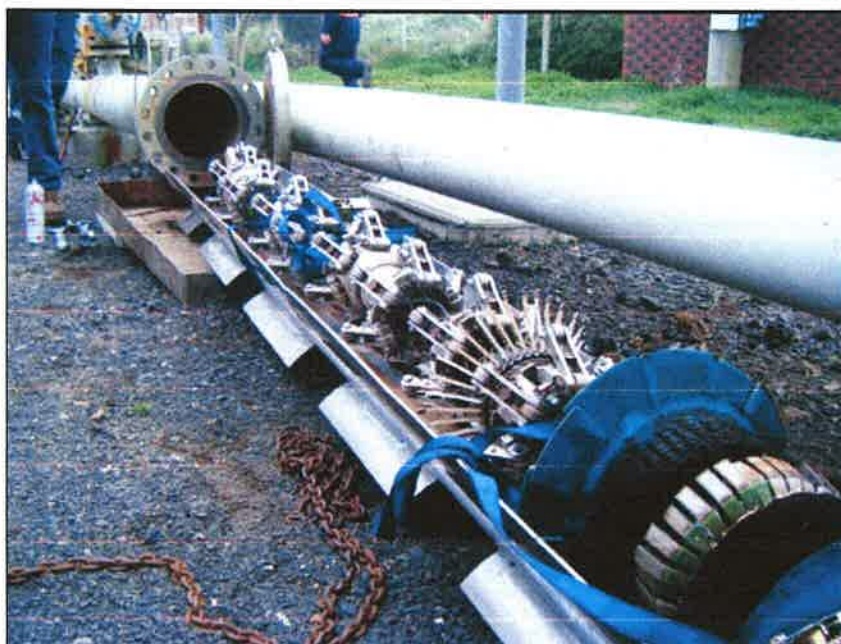
Imagine 1 Dispozitiv inspecție și curățare (Godevil)
