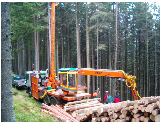
Fig.2 Funicular mobil montat pe camion
