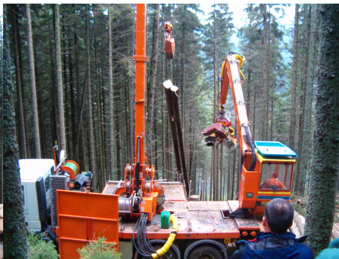
Fig.3 Sarcina de lemn adusă din aval spre funicular (varianta optimă de funcționare)
