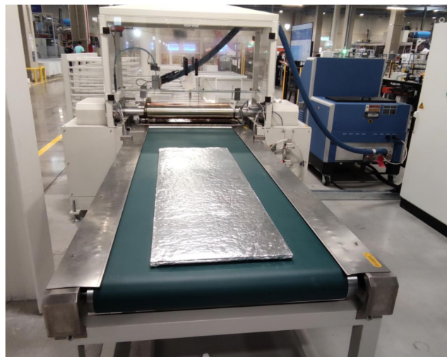
Fig.2 Linie automatizata lipire componente
