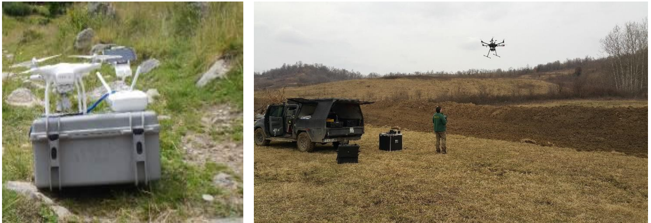
Figura 21. Drona DJI Phantom III-Advanced pregătită de zbor (stânga); Dronă DJI Matrice 600 PRO cu unitate LiDAR
