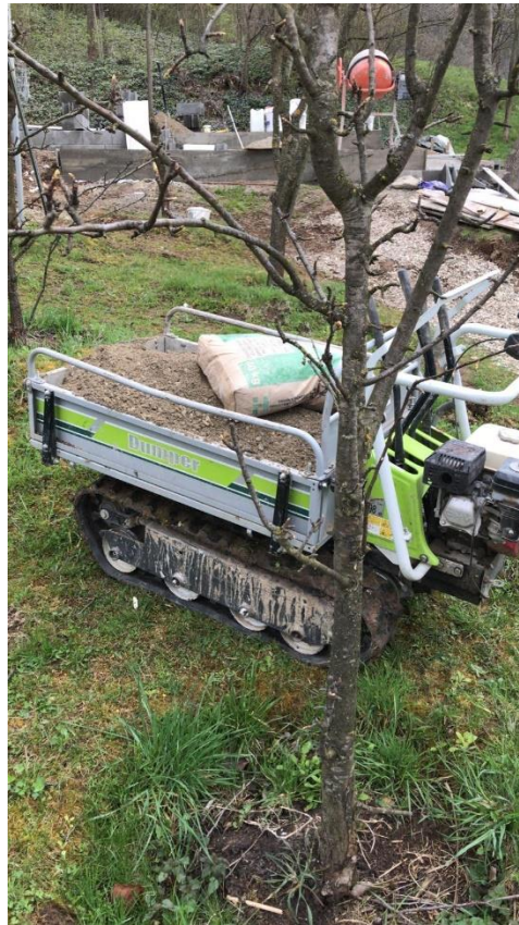
Figura 8. Minidumper pe șenile din cauciuc a cărei utilizare pe terenuri fragile asigură o protecție a solului și a covorului de vegetație
