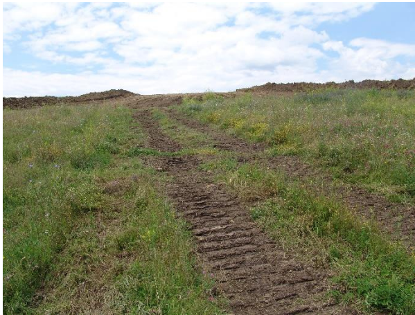
Figura 36. Aspect al unui teren înnierbat afectat de circulația unor utilaje pe șenile (stânga), respectiv pe cauciucuri (dreapta)
