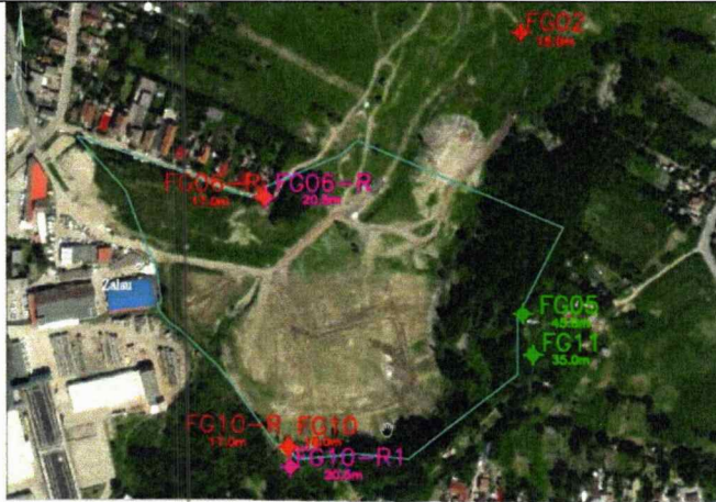
Poziție foraje echipate inclinometric FG02, FG05, FG06, FG06-R, FG10, FG10-R, FG10-R1, FG11
