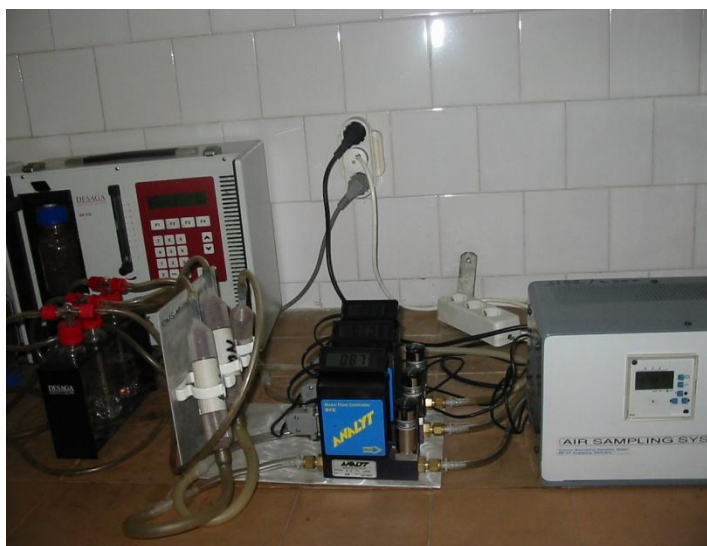
Fig. 2.3.2. Prelevatorul cu 3 canale a poluanților gazoși
