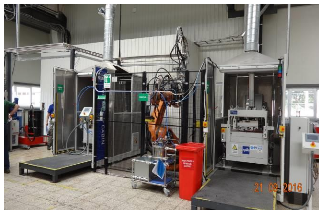
Mașini de injecție individuale și utilaj de alimentare
