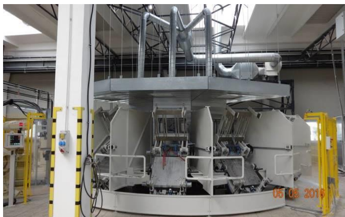
Mașina cu reacție tip carusel
