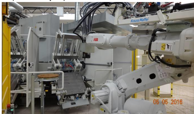
Robot de alimentare la echipament
