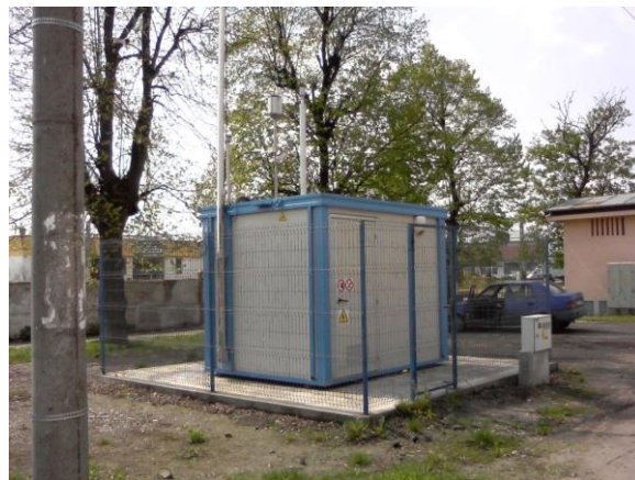
Figura I.1.1.1.4. Stația de automată de monitorizare a calității aerului SM2
