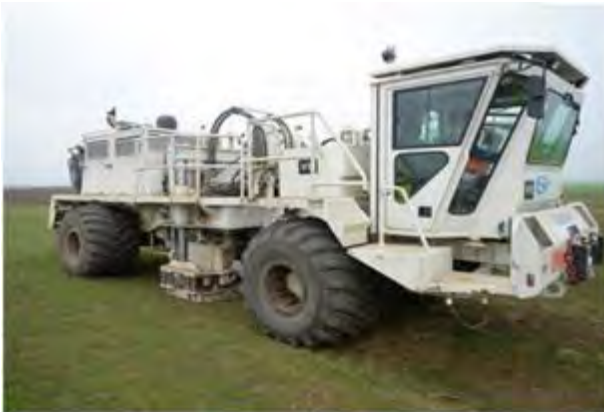
Fig. 11: Vehicul tip Vibroseis echipat cu presa centrală
