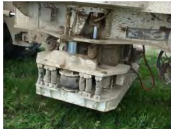
Fig. 12: Presa vehiculului Vibroseis
