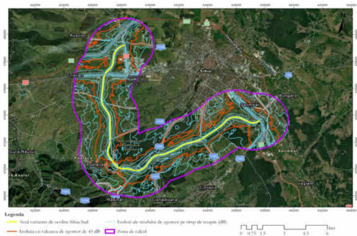
Figura nr. 45 Rezultatele modelării de zgomot pe timp de noapte în etapa de operare – scenariul anului 2050 (impact cumulativ cu traficul existent din zona de studiu)
