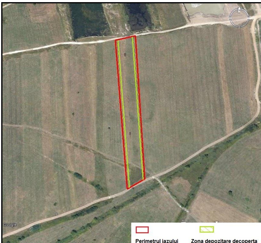
Fig. 4 – Zonele de depozitare decoperta (sol vegetal) in timpul executiei iazului Cristian – Dinel 6
