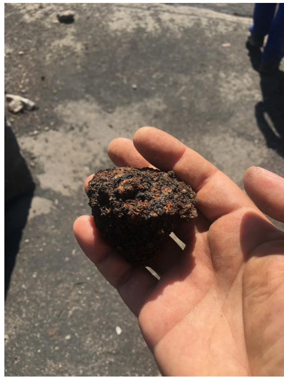
Cuptorul Waelz existent și imagine a produsului finit – clincher Waelz (înregistrat REACH) – rezultat în urma procesului de valorificare a zgurii de furnal
