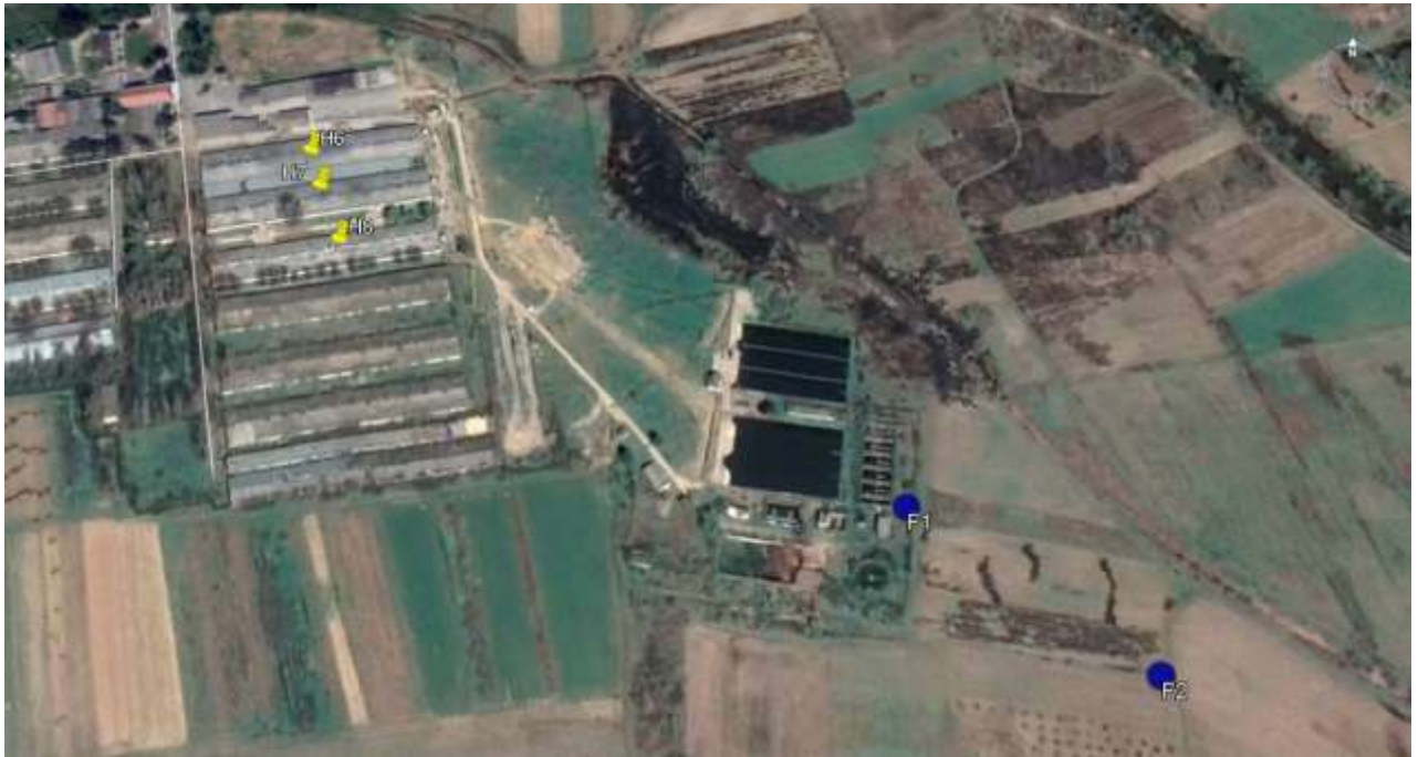
Figură 3 – Puncte investigate privind calitatea apelor subterane – F1 (fermă – aval depozit dejecții) și F2 (exterior fermă)
