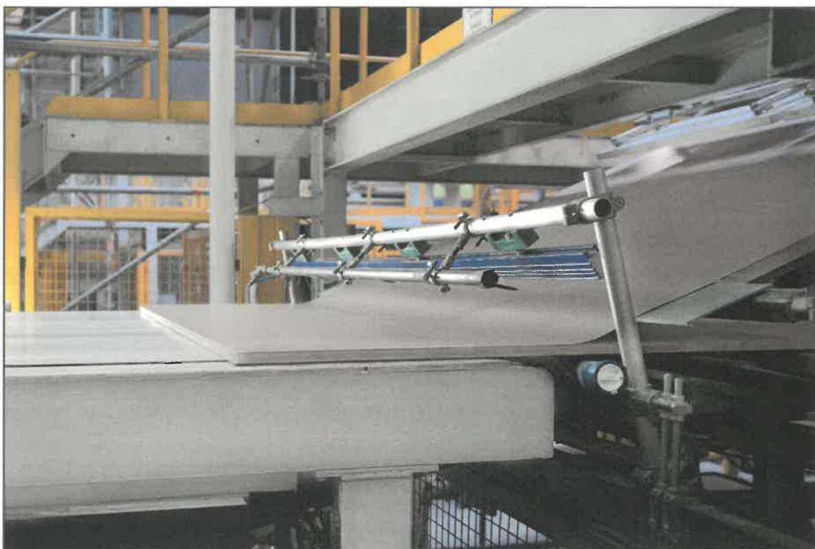
Foto 1 – Acoperire placă PAL cu hârtie impregnată
