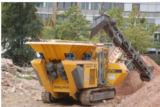
Fig. 09: exemplu de concasor mobil pentru DCD
