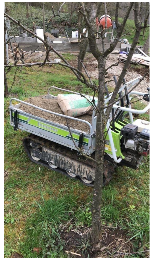
Figura 2. Minidumper pe șenile din cauciuc a cărui utilizare pe terenuri fragile asigură o protecție a solului și a covorului de vegetație
