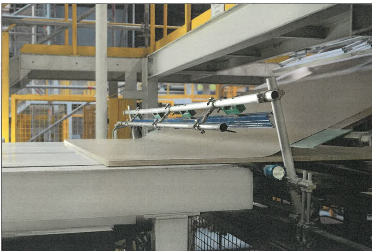
Foto 1 – Acoperire placă PAL cu hârtie impregnată
