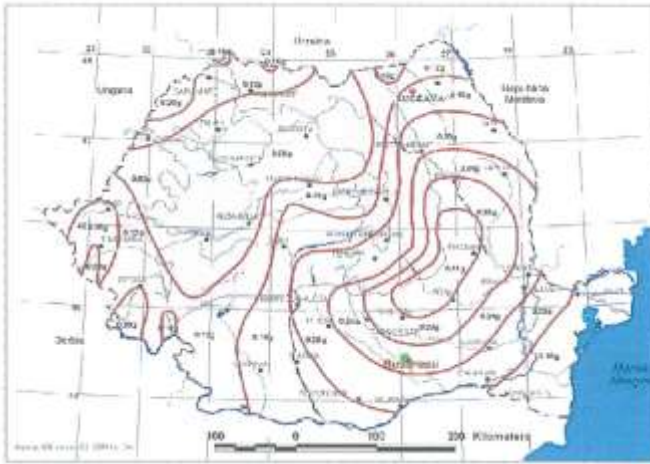
Fig. 4. Zonarea teritoriului României în termeni de valori de vârf ale accelerației terenului pentru proiectare ag pentru cutremure având intervalul mediu de recurență IMR = 100 ani
