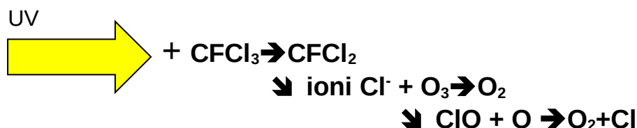
Figura 8.3.1.4. - Mecanismul distrugerii stratului de ozon de către atomii de Cl din moleculele de CFC
